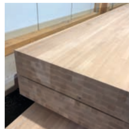
Fertige Träger aus Stabbuche im Werk Les Breuleux – bereit für die Auslieferung.
